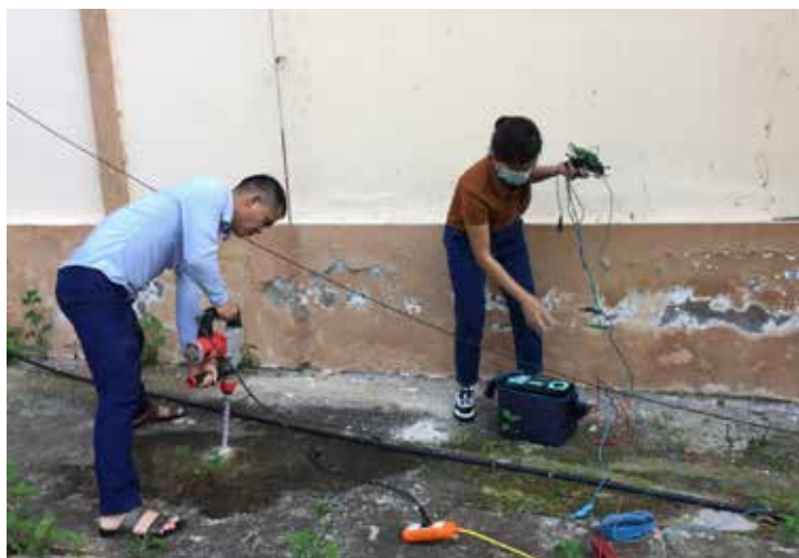
Thử nghiệm viên thực hiện đo điện trở hệ thống tiếp địa, chống sét tại Chi cục thuế huyện Điện Biên Đông.
